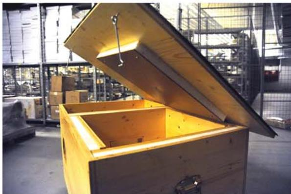
WÄRMEDÄMMUNG FÜR INNENRAUM AUF DECKEL ANBRINGEN. ZUM SCHUTZ GEGEN FEUCHTIGKEIT KANN DER DECKEL NOCH MIT DACHPAPPE EINGEDECKT WERDEN.
